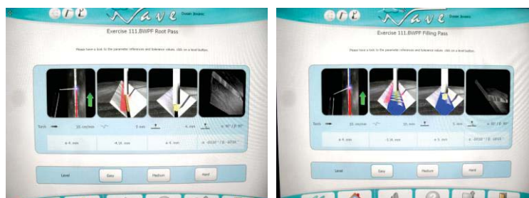
Slika 2. Definisanje parametara zavarivanja za koreni prolaz i popunu
