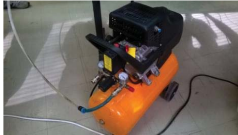
Slika 9. Izgled pneumatskog agregata
