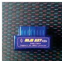
Slika 2. Interfejs za bežičnu komunikaciju ELM 327
