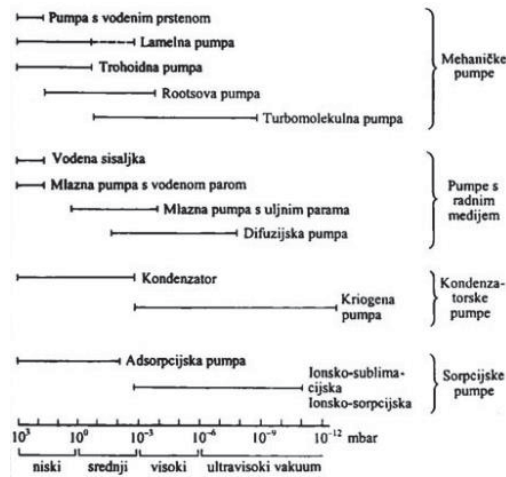
Slika 4. Nivoi vakuuma kao i kojim pumpama se on može ostvariti
