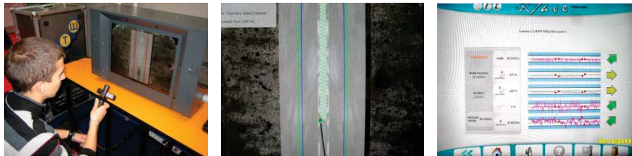
Slika 3. Rad na simulatoru zavarivanja CS Wave i rezultati virtuelnog zavarivanja
