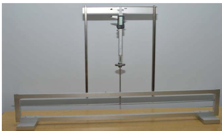
Slika 2. Izgled uređaja za određivanje modula elastičnosti
