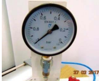
Slika 8. Pokazivanje vakummetra za nivo ostvarenog vakuma
